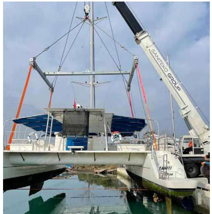
Aujourd'hui, grâce au développement des technologies, dans les chantiers navals nous gérions la sortie de l'eau et la manutention des bateaux avec des grues et des «travel lifts». On commence aussi à considérer la nécessité de nouveaux équipements positionnement au sol.
